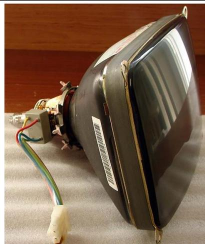
Afin de créer une image à partir de nombreux points lumineux, il est nécessaire de dévier le faisceau d'électrons au moyen d'un champ électrique ou magnétique afin qu'il frappe l'écran au point voulu. Ces deux mécanismes, ainsi que le dispositif d'accélération qui crée le faisceau d'électrons, sont étudiés dans les questions suivantes. Nous n'utilisons ici que la physique classique, et l'action de la gravité est négligée.
