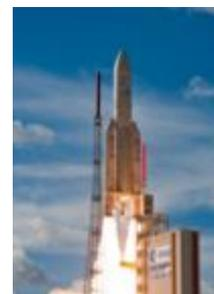
En route vers l'orbite du satellite, la fusée de lancement s'est d'abord dirigée vers une "orbite de stationnement" circulaire à une altitude de 175 km au-dessus de la surface de la Terre. Sur cette orbite, la fusée recalcule des imprécisions survenues lors du lancement et se dirige ensuite vers l'orbite géostationnaire visée.
